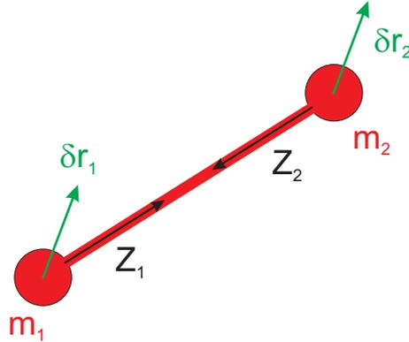
Die Zwangskräfte, die die beiden Massenpunkte auf festem Abstand halten, erfüllen nach dem 3. Newtonschen Axiom  $\vec{F}_{z1} = -\vec{F}_{z2}$ . Wenn nun beide Massenpunkte dieselbe virtuelle Verrückung  $\delta\vec{r}_1 = \delta\vec{r}_2$  erfahren, die mit der Zwangsbedingung verträglich ist, so sind die einzelnen virtuellen Arbeiten zwar ungleich Null, aber für die gesamte gilt
