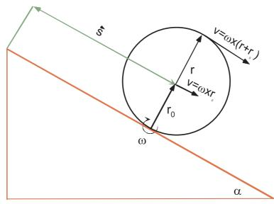
Alternativ kann man die Kontaktachse mit der schiefen Ebene als Drehachse betrachten. In diesem Fall wird die Translation mit beschrieben.
