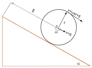
Ein Zylinder mit Radius R rollt eine schiefe Ebene hinunter. In dieser Darstellung wird die Bewegung als Rotation um seine Achse plus eine Translation mit der Geschwindigkeit  $\dot{\vec{s}}$  dargestellt.
